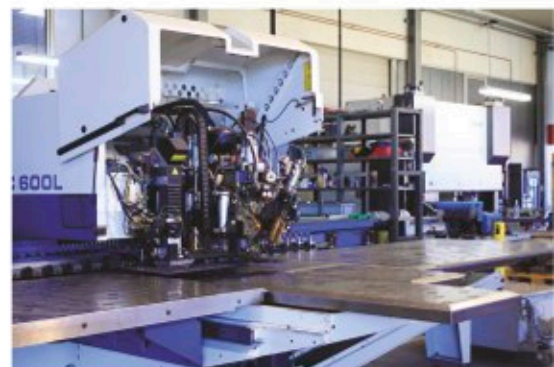
Combiné de découpe laser et poinçonnage, avec chargement et déchargement automatique.
