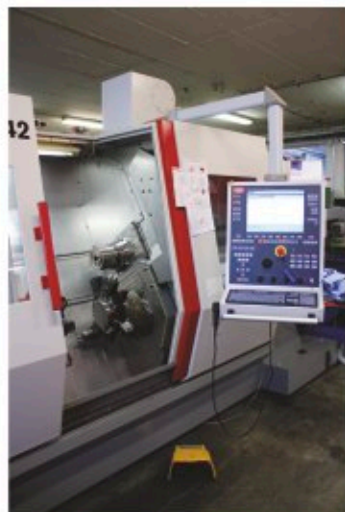
Centre de fraisage et de tournage, à quatre supports d'outils indépendants.
